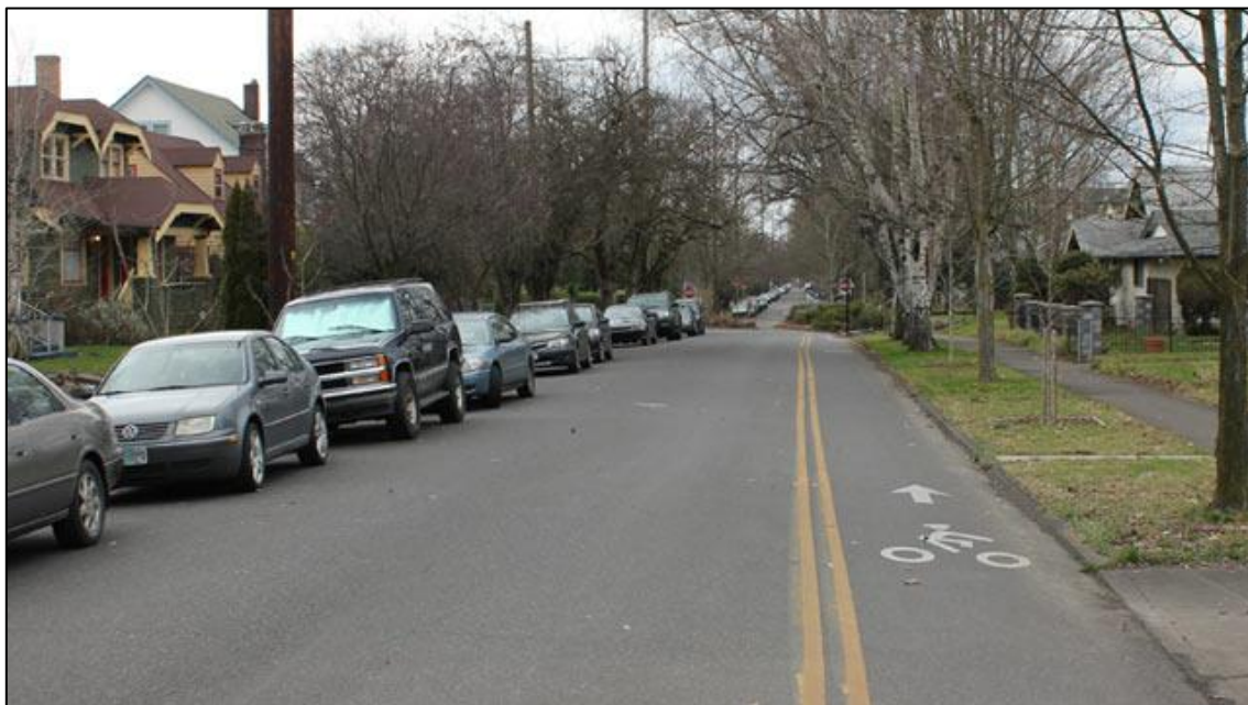
شکل ۸-۲- نمونه خط‌کشی مسیرهای دوچرخه خلاف جهت
